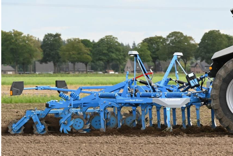
Bild 2: LEMKEN iQblue flow control überwacht den Materialfluss im Zinkenfeld in Echtzeit.
