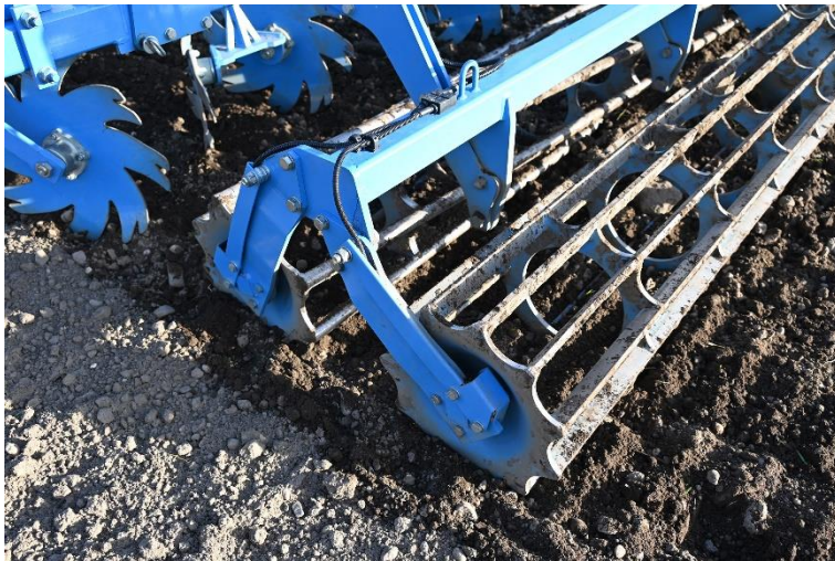
Bild 3: LEMKEN iQblue slippage control misst kontinuierlich den Walzenschlupf.
